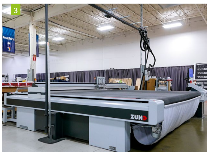
1) Doug Buchanan posa davanti a una delle due ATP Color da 3,2 m utilizzate da Renze Display per stampare a sublimazione tessuto in poliestere. 2) Le postazioni prestampa, al centro del reparto stampa e finitura. 3) Il plotter da taglio Zünd 3XL-3200. 4) Matt Rusek, responsabile del reparto finitura, cuce alcuni teli stampati.
