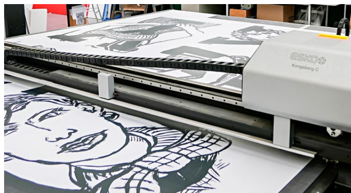
|| A sinistra, la stampante ATPColor DFP2000 installata nel reparto produzione di ALPAC a Rovello Porro (Como). A destra, uno dei due plotter da taglio in piano configurato per la finitura di materiale flessibile.
